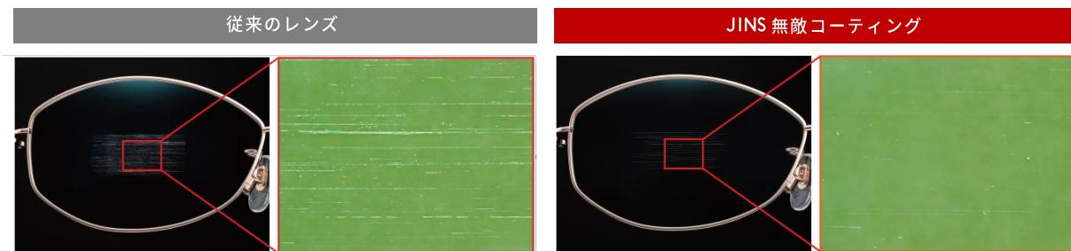
※耐擦傷性能評価テスト：砂消しゴムに3kgの重荷をかけてレンズ面を5回スクラッチ
